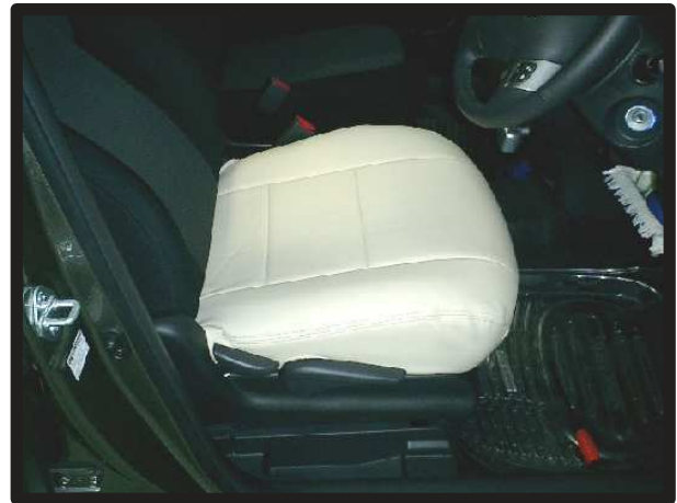
⑪シートリフターを外した時と逆の手順で取り付けます。カバーのラインを整えて1列目座面の完成です。助手席側は一部形状が異なりますが、同様に付けます。
