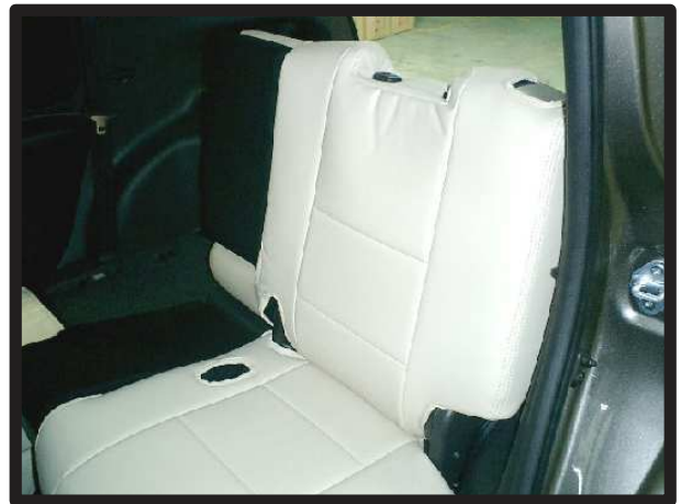
⑫カバーのラインを整えて2列目背もたれの完成です。
