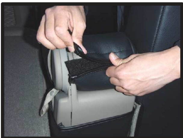
⑨引き出した生地とカバー背面の生地をマジックテープで固定します。
