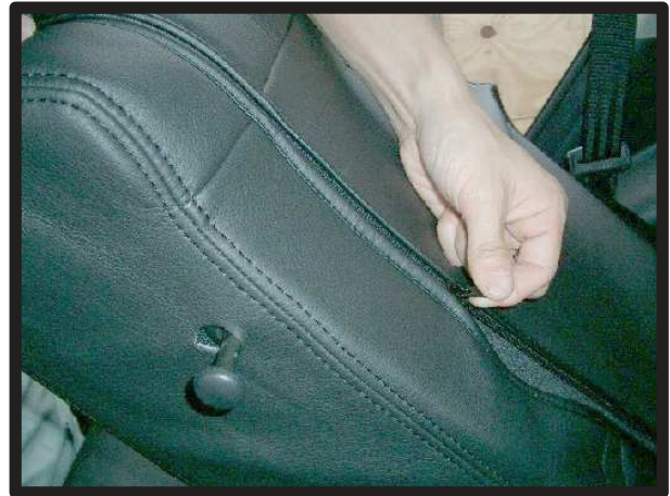
④背もたれを引き倒し、カバー背面のファスナーを下まで閉じます。
