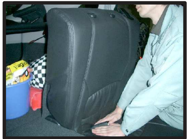
⑥背もたれと座面の隙間に、生地を入れ込んでいきます。
