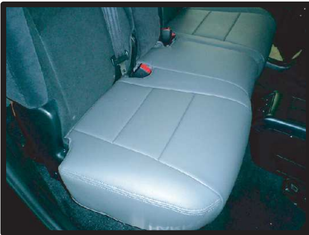
⑧カバーのラインを整えて2列目運転席側座面の完成です。 助手席側は一部形状が異なりますが同様の取り付け方法で行います。ベルトの固定位置だけ次の写真で確認下さい。
