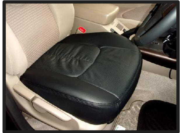
⑪カバーのラインを整えて1列目座面の完成です。 助手席側も同様に取り付けます。
