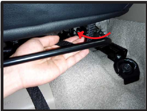
⑨カバー前部にあるベルト（2本）を座面下のスライドレバーの上を通して背面から引き出します。
