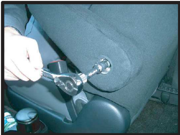
②ソケットレンチを使用し、アームレストを取り外します。
