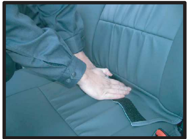
④背もたれと座面の隙間に生地を入れ込み、後ろ側から引き出します。
