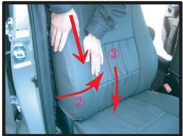
⑥図の①～③の順番にカバーをなでるようにして、シートに馴染ませていきます。④で入れ込んだ部分と背もたれ下のマジックテープ同士を固定します。
