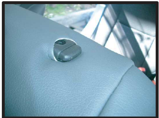
⑤ヘッドレストの台座部分を穴から取り出します。生地伸びを利用して横から潜り込ませるように取り出します。
