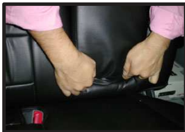
⑥アームレスト下部のカバーをシート との間に入れ込み、アームレスト後 側にてマジックテープで固定します。
