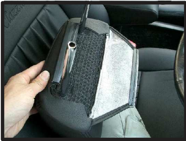
④ヘッドレストを背もたれから取り外して、底面のカバーをかぶせます。
