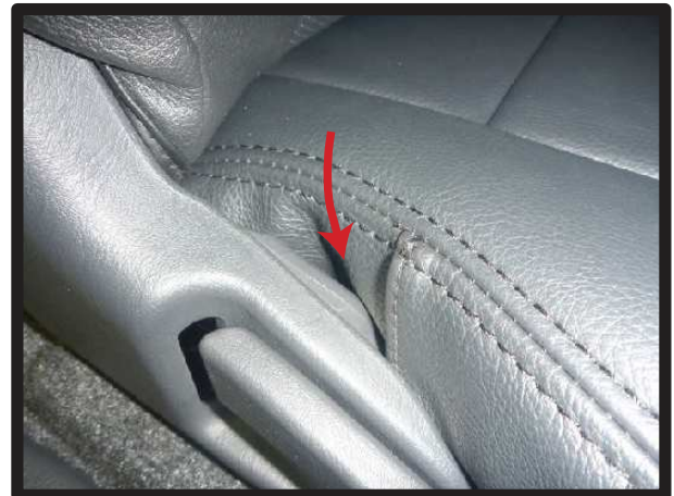
⑪シート外側面のリクライニングレバー周りの生地をシートの隙間に入れ込みます。 多少形状は異なりますが内側面も同様に生地を隙間に入れ込みます。
