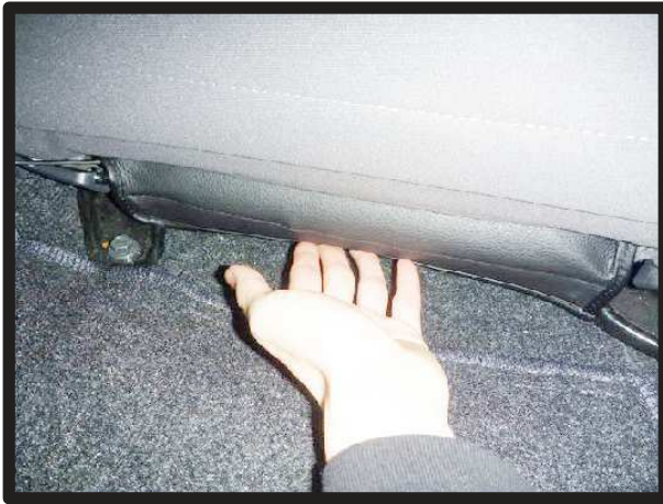
⑦引き出した生地マジックテープをシートに直接固定します。
