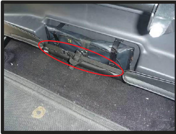
⑦図の○の部分で示したベルトとバックルを固定します。 ※ベルトの位置は本ページ最後の全体図をご覧ください。 (⑦で示しています。)
