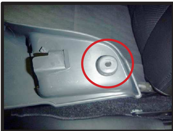
⑨ネジで止まっているプラスチック部分を裏から見ると図のようになっており、○で示した突起部にカバーの加工穴の位置を合わせます。
