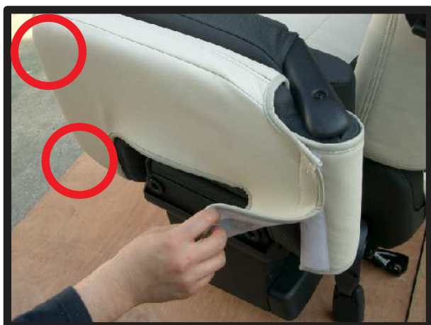
②シートの角にたるみがないようにかぶせて、マジックテープでしっかりと固定して下さい。
