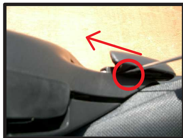
②ツメで固定されているのでヘラなどでツメを広げて抜いて下さい。
