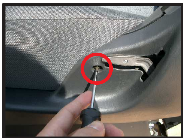
③プラスドライバーでカバーについているネジを外します。
