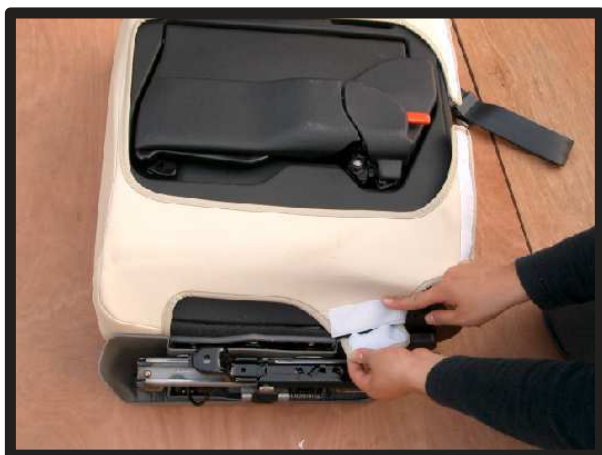
③マジックテープで固定して座面部分は完成です。
