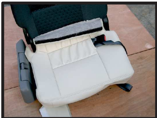
①座面カバーをかぶせます。シートベルトを穴から取り出しておきます。
