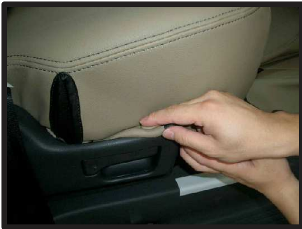
⑧ シート側面のプラスチックカバー部に、生地を入れ込みます。
