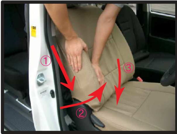
⑦①～③の順にカバーをシートに馴染ませるように形を整えます。
