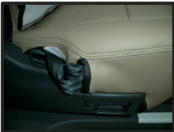
⑨ ③で取り出したシートベルトを、カバーの切れ込み部からシートに収納します。
