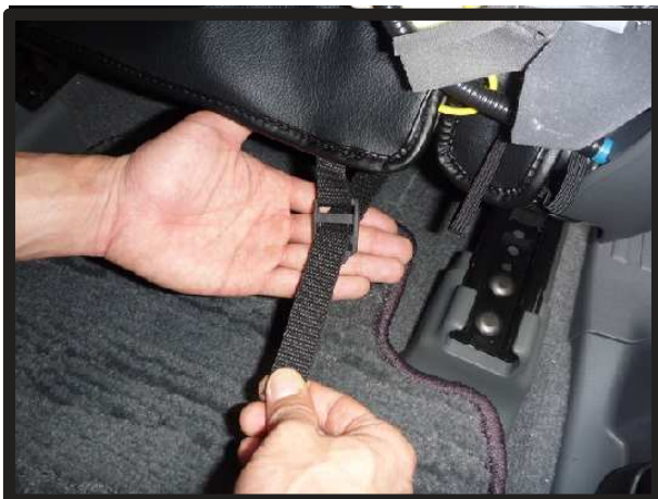
⑨背面からベルトを引き出し、固定します。
