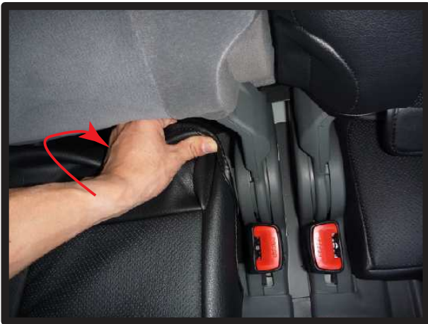
②シートの付け根部分を巻き込むように生地を入れ込みます。
