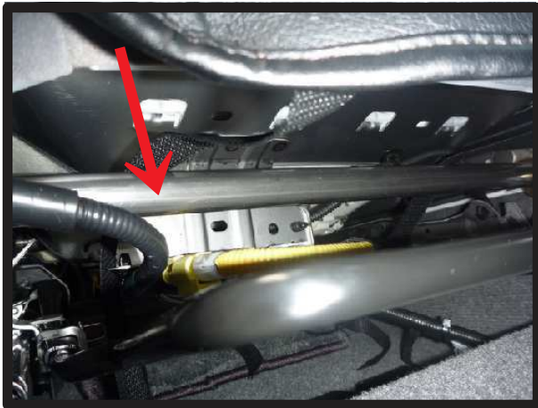
⑧ベルトはスライドレバー、矢印部分の金属バーの上を通しシート背面へ回します。
