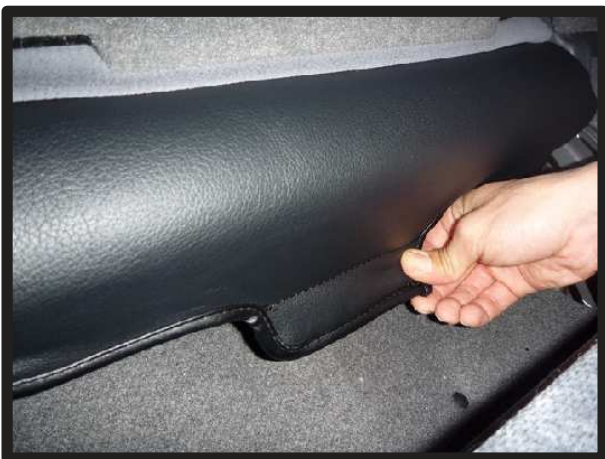
③背面から入れ込んだ生地を引き出しマジックテープでシート本体に固定します。
