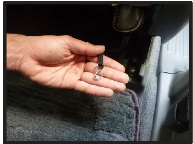
⑪⑤で引き出した生地に付いているゴムに、付属のS字フックを取り付けます。S字フックは座面裏の金属部分に引っ掛け固定します。
