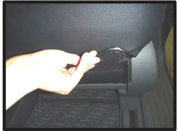
⑦引き出した生地をシート背面のカバーとマジックテープで固定します。
