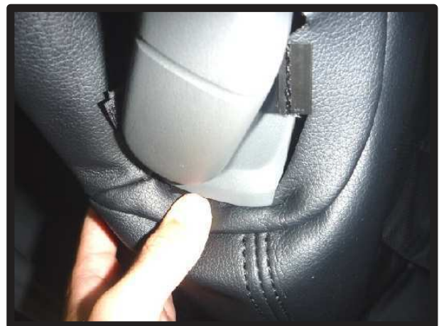
⑨黒いプラスチックの板もレバーのフチに入れ込みます。板はフチから生地が、はみ出さないようするためのものです。
