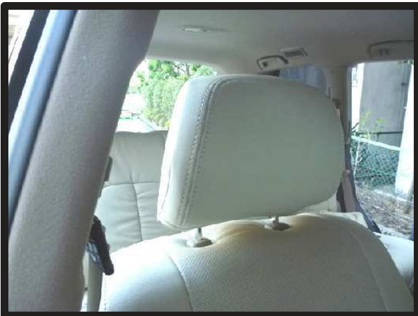
⑤ヘッドレストを背もたれに戻して1 列目のヘッドレストの完成です。 2列目ヘッドレストも形状は異なり ますが、同様の固定方法で取り付け ます。
