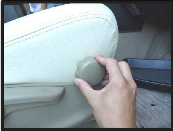
⑱シート上下アジャスターのダイヤルをシートに戻します。
