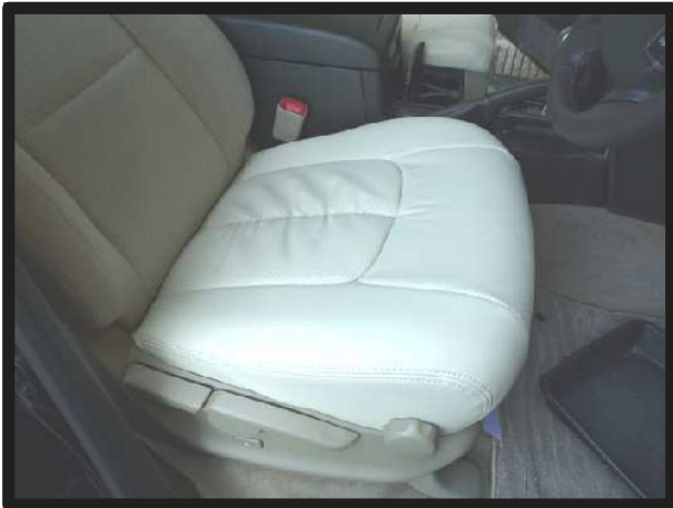
⑳シートのラインを整えて、1列目運転席側座面の完成です。 助手席側は一部シート形状が異なりますが、同様に取り付けを行います。
