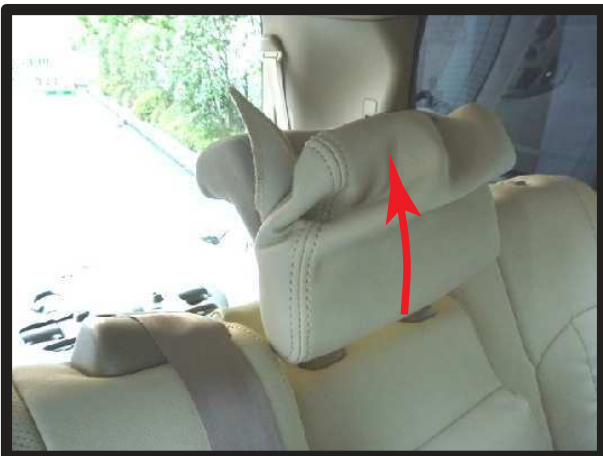
※2列目センターヘッドレストは、始 めにヘッドレストの先端にカバーを かぶせて、矢印方向に持ち上げるよ うにかぶせていきます。
