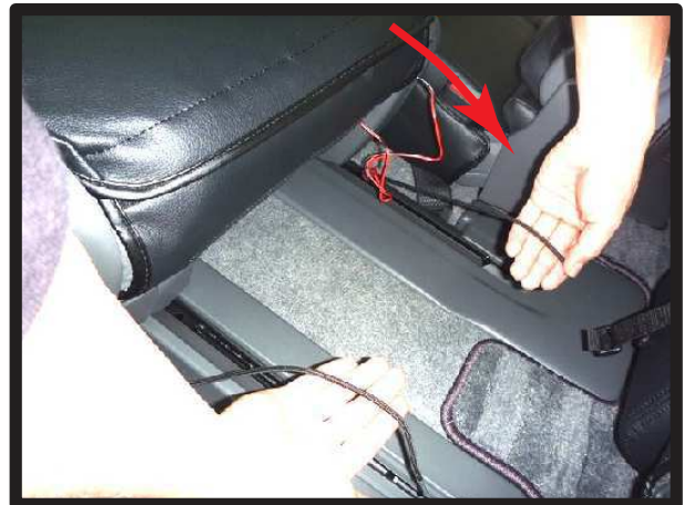
㉒助手席側の外側側面のヒモは運転席側と同様に入れ込みます。内側側面は矢印方向へ背面から引き出します。運転席側同様にヒモを結び留めた後にシートを前後にスライドさせて、ヒモが干渉していないか確認して下さい。
