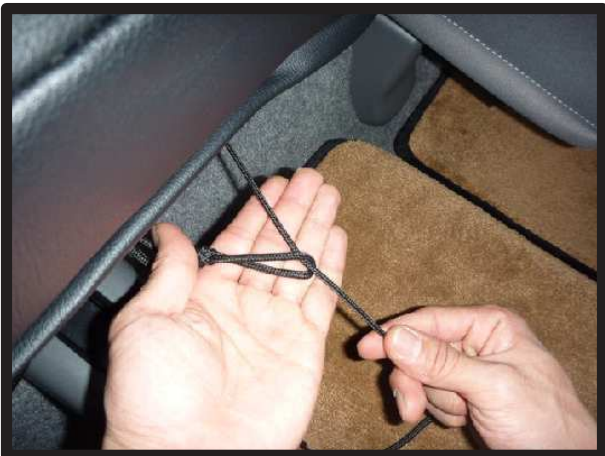
㉑もう片方のヒモをその輪に通して引き込みます。座面下回りが絞り込まれ固定されます。ヒモは強く引きすぎると切れますので、ご注意ください。またヒモを結んだ後にシートを前後にゆっくりスライドさせて、ヒモがシートレールに干渉していないか確認して下さい。
