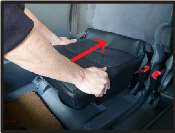
①カバーをシート前方から矢印方向へかぶせます。
