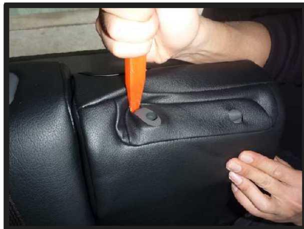
⑤ヘッドレストの台座を取り出します。3列目背もたれと同様に隙間が大変狭いためヘラのようなものを使用して台座を取り出して下さい。
