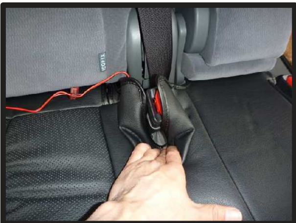
㉓シート中央のシートベルトバックル部分に生地を入れ込みます。
