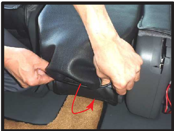
②シートを前に倒してカバーを矢印の方向に包み込むようにかぶせます。シート本体を押し潰しながらかぶせて下さい。
