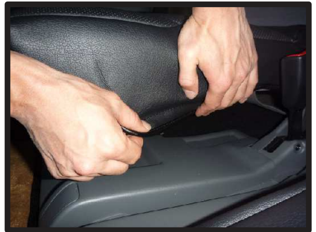
⑤シート両側面裏にもマジックテープでシート本体に固定します。
