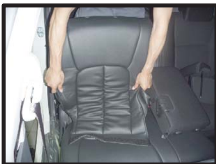
③シートのラインに合わせカバーをかぶせます。
