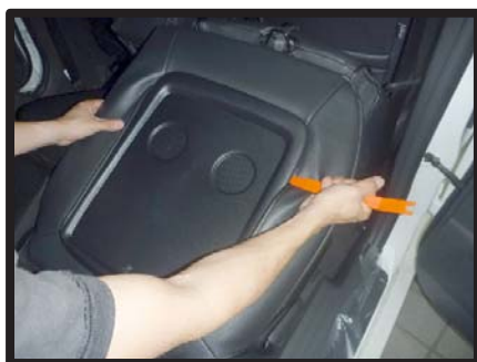
⑨背もたれ裏のバッグテーブルのフチに生地を入れ込みます。
