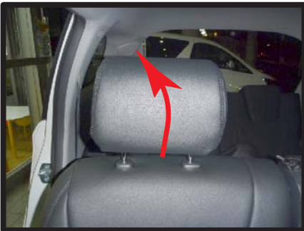
⑥ 2列目ヘッドレストは、くの字になっているため矢印の方向に下から覆うようにかぶせていきます。
