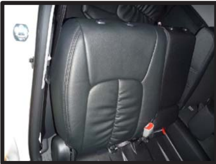
⑫2列目背もたれの完成です。助手席側は一部形状が異なりますが同様の固定方法で取り付けを行います。
