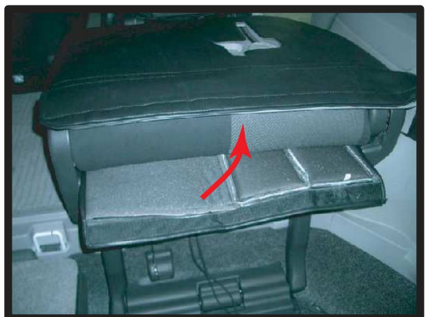
⑤座席後方に回り④で入れた部分を引き出して、背もたれ背面(→の部分)にマジックテープで固定します。
