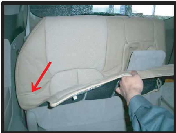
②センターアームレスト付きの場合はシートカバーの穴に通しておきます。また、矢印部分のリクライニング用レバーもこのときに取り出しておいて下さい。
