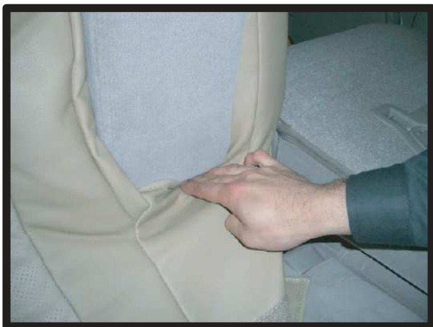
③アームレスト下の生地を図のように入れ込みます。アームレスト収納部分のマジックテープはこのあとアームレスト取り付け時に固定します。
