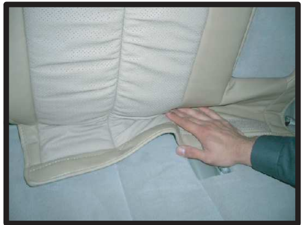
④背もたれと座面の間にシートカバーを入れ込みます。
