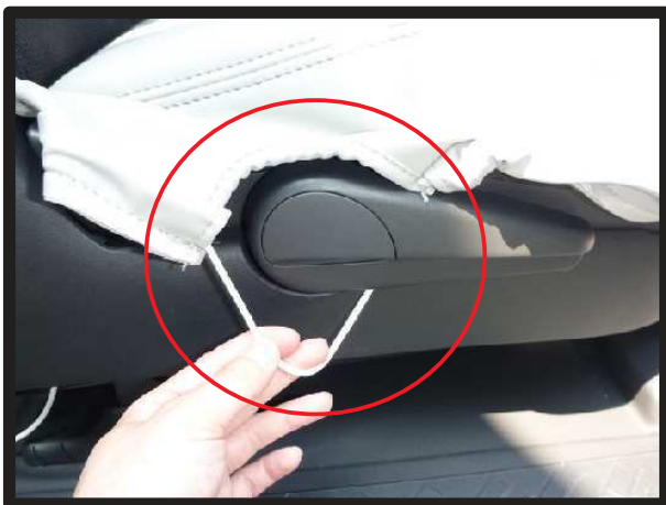
⑨ラチェット式シートリフター部（○部）は、カバーに付いているヒモが図のように、下側を通るようにして下さい。
