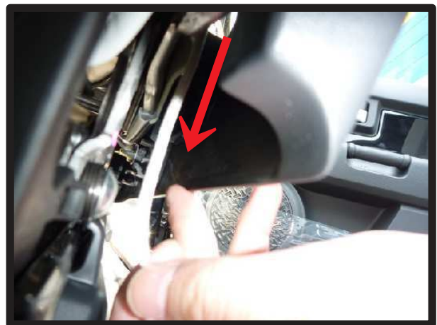
⑫入れ込んだヒモを、シート下側から取り出し、後ろ側へ引き出します。カバー内側面のヒモは、シート側面を沿わせ、後ろ側へ引き出します。
