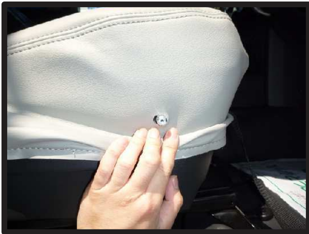
⑧シートリフターダイヤルの軸を、カバーの加工穴から取り出します。
