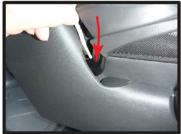
⑪カバー外側面のヒモを、リクライニングレバーの隙間に入れ込みます。
