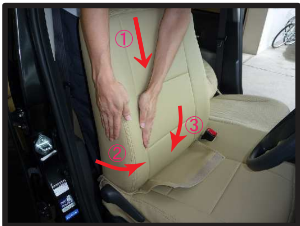
⑥①～③の順番にカバーをなで下ろしてシートに密着させるようにしわをなくしていきます。
