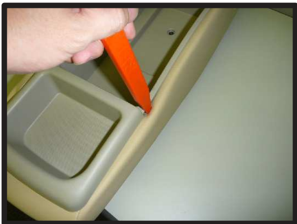
⑩アームレスト本体とボックスの間に生地を入れ込みます。
