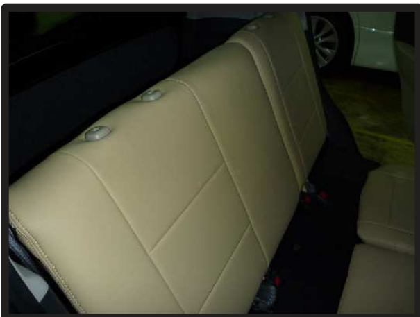
⑨カバーのラインを整えて2列目背もたれの完成です。 助手席側も一部形状が異なりますが、同様に取り付けます。
