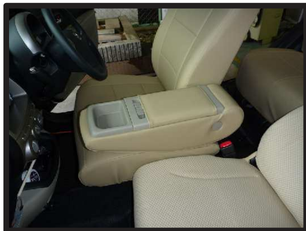
⑮アームレストを運転席に戻して完成です。 ボルト隠しのキャップはカバーの上から付けます。
