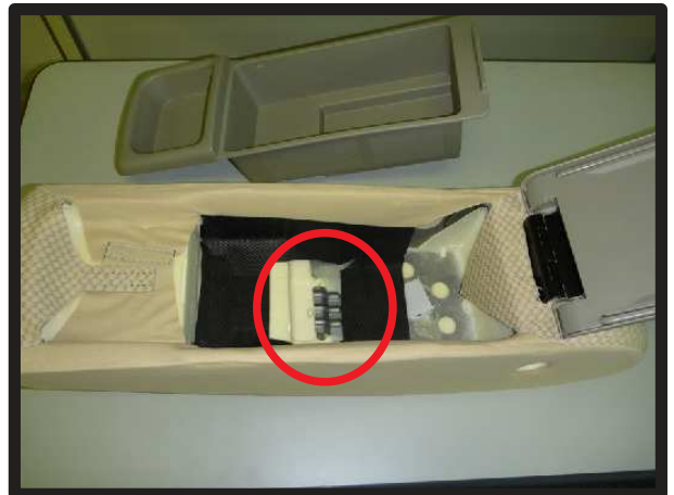
②図の赤丸部分がボックス裏側に引っかかっているなので、ボックスを前側にスライドさせて外します。
