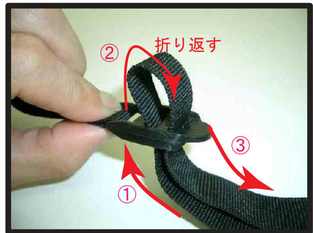
⑪バックルの固定は、①～③の順番にベルトをバックルに通してベルトを引くと、カバーの前後が引き絞り固定されます。ベルトは強く引きすぎると、縫い目から切れる恐れがありますので、ご注意ください。
