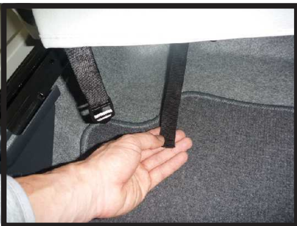
⑨カバー前方についているベルトを、シート裏を通してシート背面から引き出します。この際ベルトはスライドレバーの上を通すようにしてください。
