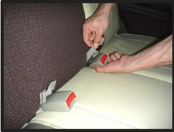
①シートにゴムで固定されているシートベルトバックルを外します。
