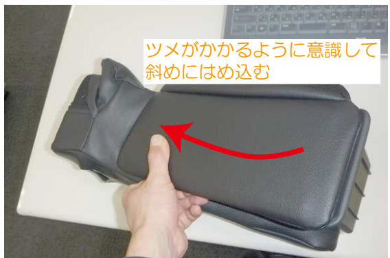
12 ボックスをアームレスト側のカバーの生地を巻き込みながら、アームレストに戻します。この際ボックス裏のツメがしっかりかかるように意識して、元に戻して下さい。
