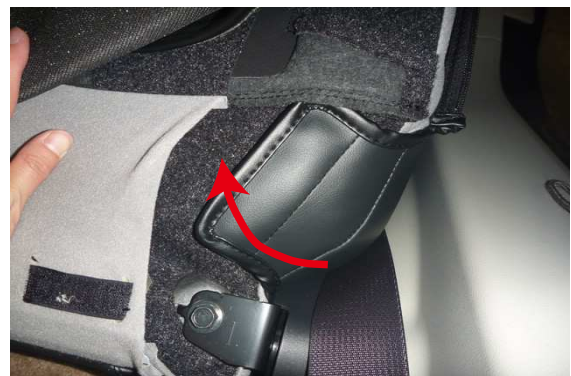
11 17ページ5番の生地をめくり上げた状態で、カバー両側面の下側に付いているマジックテープを、シートに直接貼り付けて固定します。マジックテープに保護テープが付いている場合は、保護テープを外してから固定して下さい。
