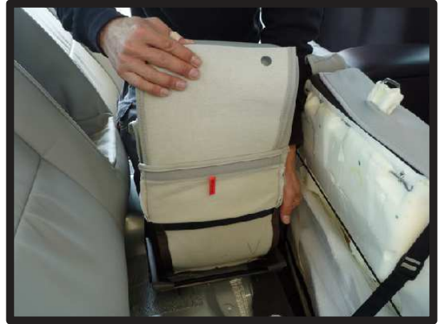
⑯⑮の生地を折り返してカバーの中へ収納するようにカバーをかぶせていきます。
