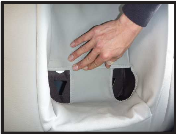
⑭アームレスト収納部の生地をマジックテープ同士で固定します。またアームレスト収納部も、シート本体に生地を押さえ付けてマジックテープで固定します。
