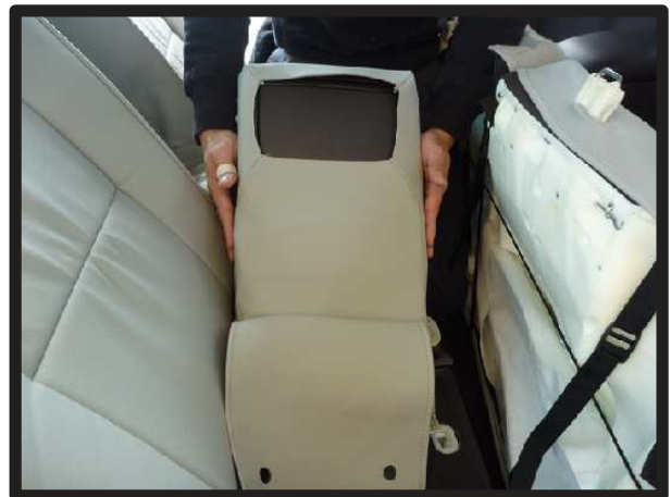
⑱マジックテープで固定すると図のようになります。
