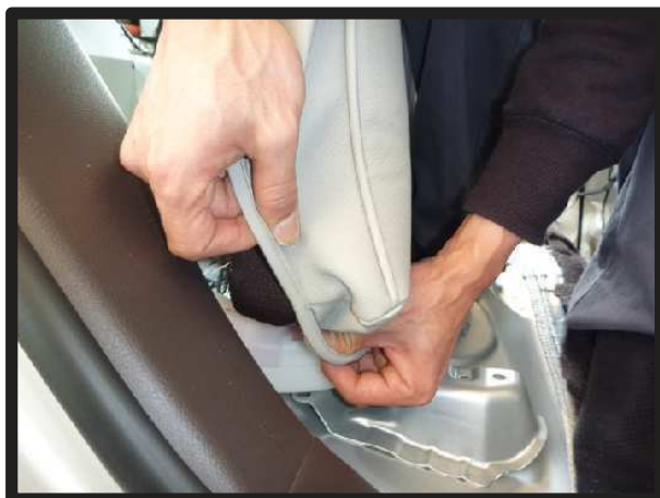
⑩シート下の角に引っ掛けるようにしてカバーをかぶせます。
