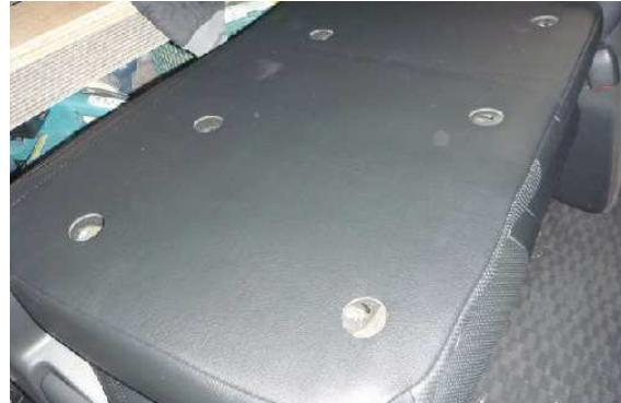
10 シートのネジ穴とカバーの加工穴の位置が合っていることを確認し、バックボードを元に戻します。
