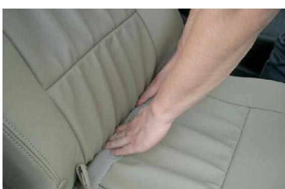
6 背もたれと座面の隙間に生地を入れ込み、
