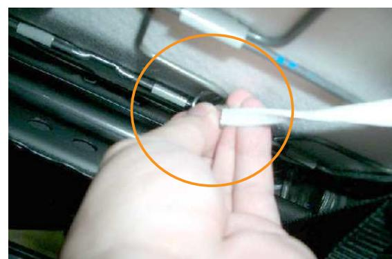
11 座面下の金具にS字フックをひっかけて固定します。
