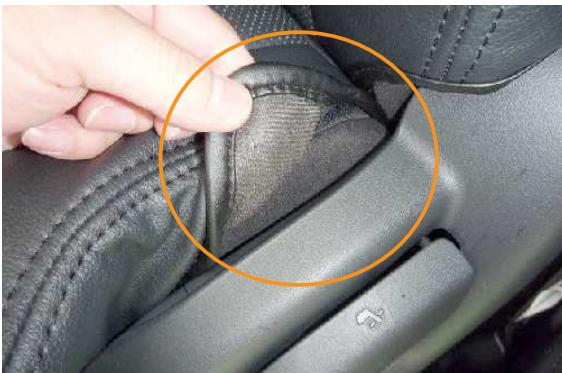
8 図の○で示した生地もマジックテープでシートに直接固定します。
