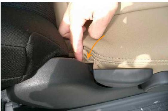
8 矢印部分の生地を図のようにシートの隙間に入れ込みます。
