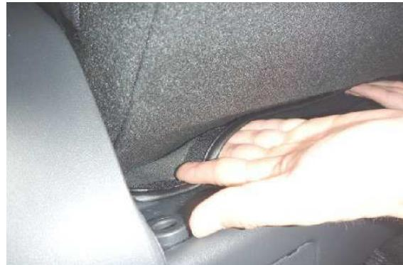
10 引き出した生地をマジックテープでシートに直接固定します。ベルトは生地を引き出す為の物ですので生地の裏側へ仕舞い込みます。
