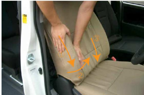
7 ①～③の順にカバーをシートに馴染ませるように、側面のシワを無くします。
