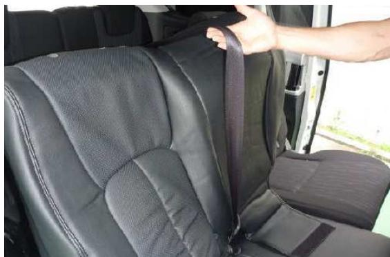
2 カバーのファスナーを開き、図のように中央シートベルトの下側を通してカバーをかぶせます。
