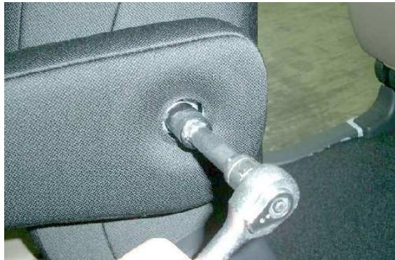
1 背もたれのカバーをつける前に、アームレストを取り外します。アームレストに付いているキャップを外し、ソケットレンチ等を使用してボルトを外します。
