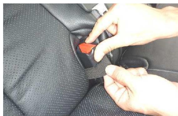
11 15ページ1番で引き抜いたシートベルトバックルの収納部に生地を入れ込み、カバーに付いているゴムでバックルを固定します。
