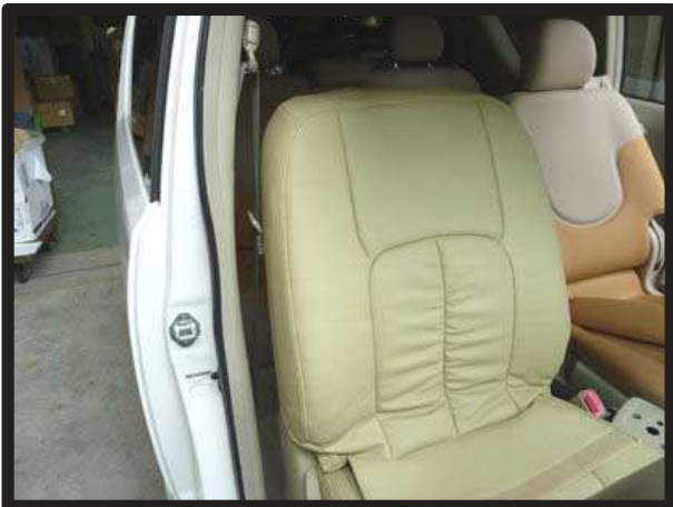
②シートラインに合わせてながらカバーを被せます。
