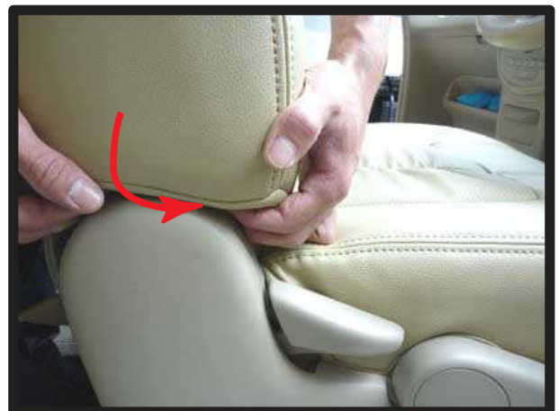
⑥図のようにシート側面下部に生地を入れ込みます。
