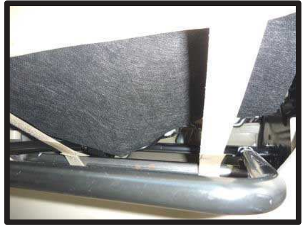
⑪⑩のマジックテープをシート裏側の金属部品に巻き付け固定します。
