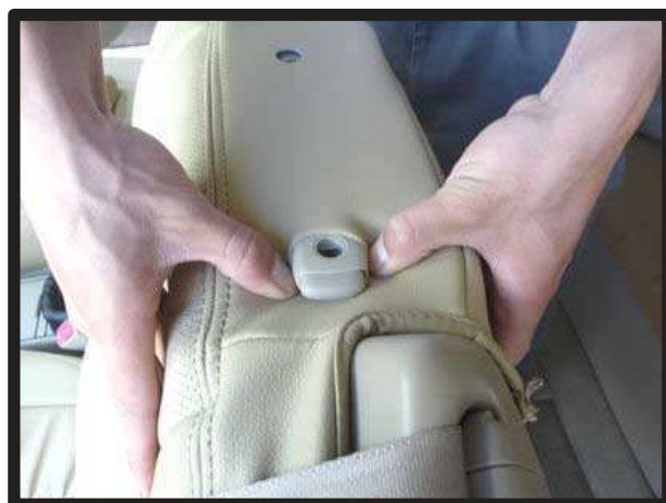
⑤ヘッドレストの台座部分をカバーの加工穴から取り出します。生地伸びを利用して横から潜り込ませるように取り出します。
