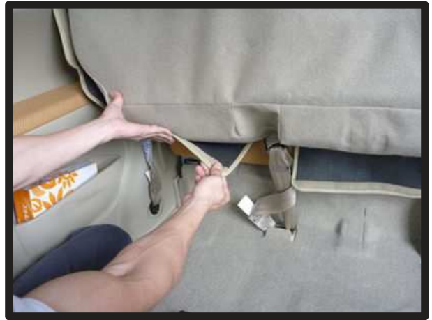
④③で入れ込んだ生地を引き出し、生地に付いているマジックテープでシート本体に固定します。
