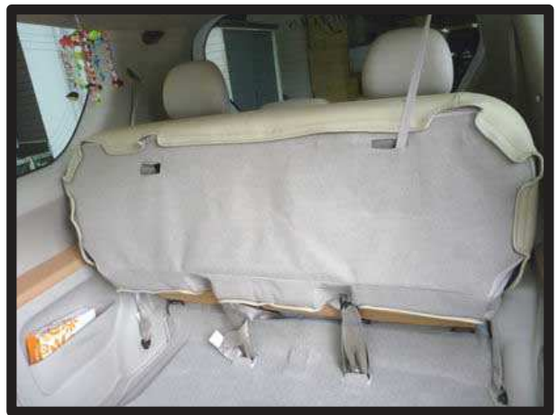
⑤シートを跳ね上げた状態にし、生地に付いているマジックテープでシート本体に固定します。
