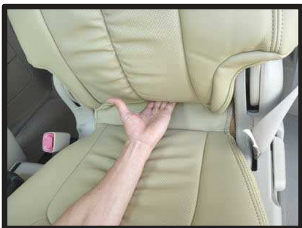
③背もたれと座面の隙間に生地を入れ込みます。背もたれの角度を調整し入れやすい位置で行って下さい。
