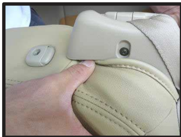
⑥シートベルト周りの生地をヘラ等を使用し、シートとプラスチック部の隙間に入れ込みます。
