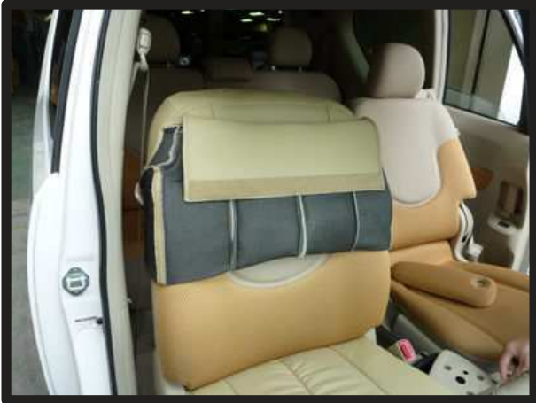
①カバーを図のように半分程裏返し、シートラインに合わせて合わせます。
