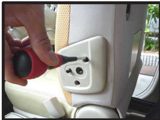
⑤ドライバーでネジを外します。
