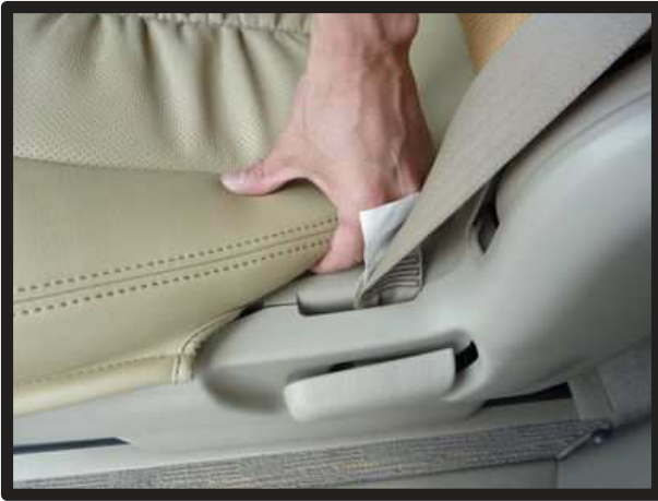
⑧⑦のゴムをシートのプラスチック部の隙間に入れ込みます。
