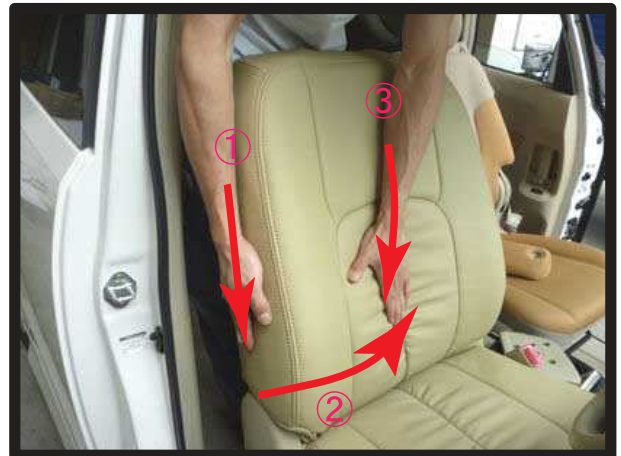
⑤①～③の手順で側面のシワをシート中央に寄せ、そのまま下になぞるようにシート側面のシワが無くなる迄カバーをシートに馴染ませます。
