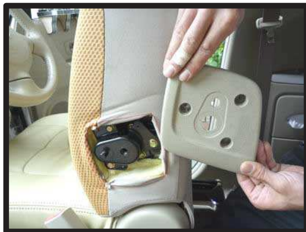
⑥背もたれのプラスチック部品を外します。
