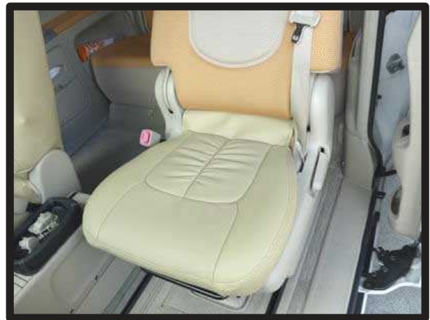
⑫カバーのラインを整え1列目助手席座面の完成です。
