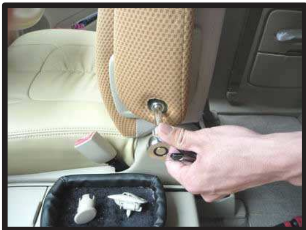
②ラチェットレンチ等でアームレストを外します。 (ソケット14mm)
