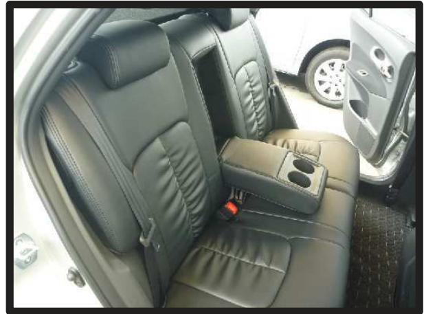
⑯カバーのラインを整えて、2列目背もたれの完成です。 助手席側も一部形状は異なりますが同様に取り付けます。
