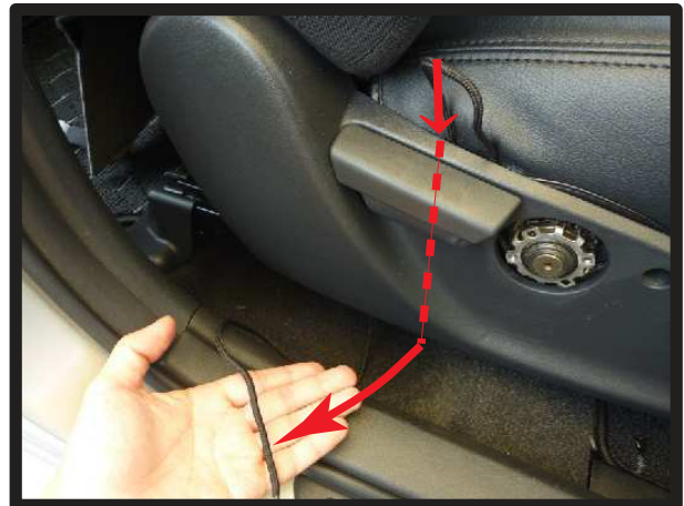
⑪ カバー外側面のヒモは、図のようプラスチック部の中を通してシート裏から引き出します。 ※内側面のヒモはそのままシート背面へ出します。
