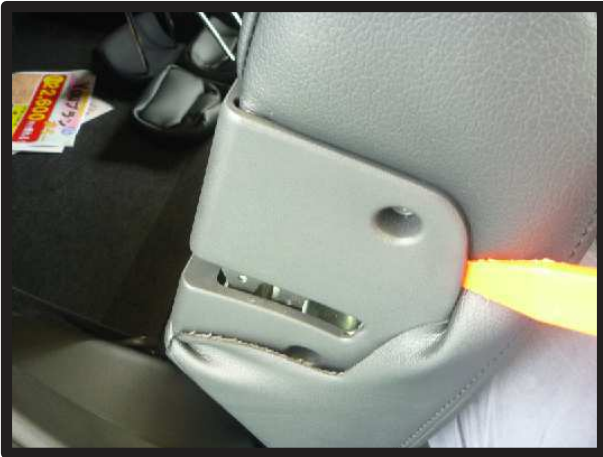
⑮背もたれをロックする部分のプラスチックの隙間にも、生地を入れ込みます。
