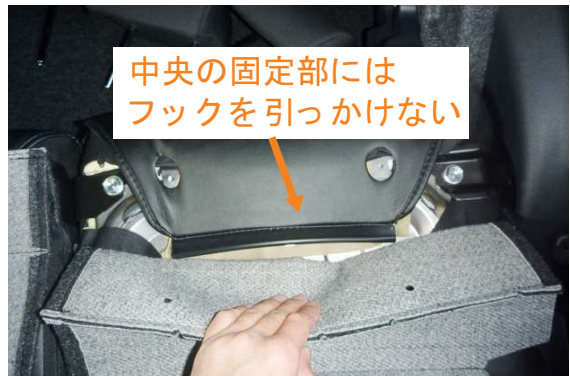
30 助手席側も一部形状は異なりますが、同様の固定方法で取り付けます。助手席側のシート背面の固定部は3箇所ありますが、両端の2箇所にのみフックを引っ掛けて固定します。(中央は固定しません)
