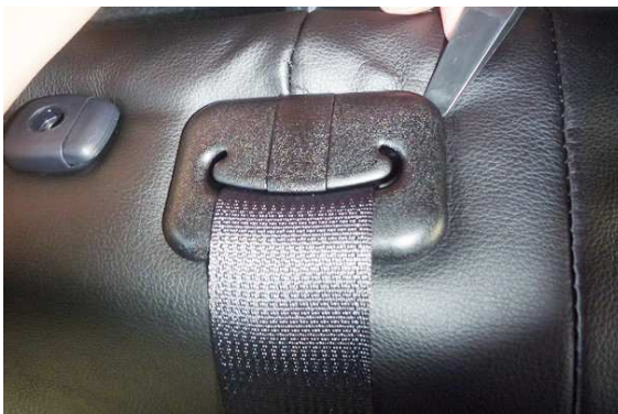
27 中央のシートベルトが出ているプラスチックのフチに生地を入れ込みます。
