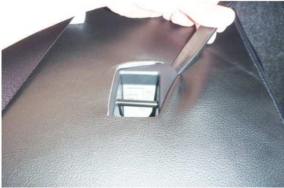
25 チャイルドシート固定用のアンカー部分のフチに生地を入れ込みます。
