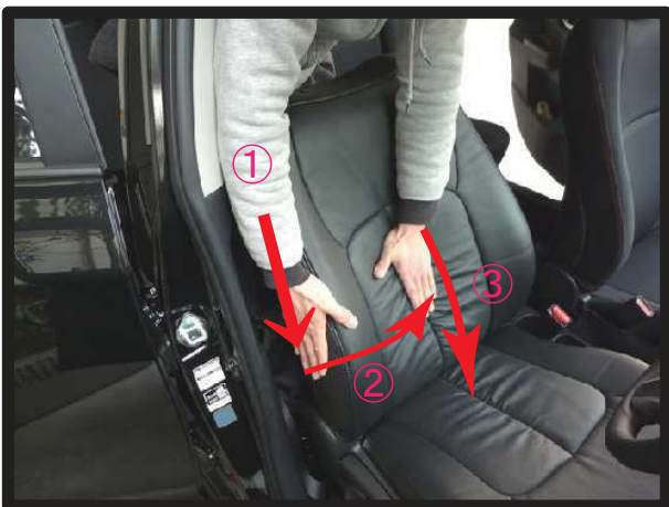
⑥図の①～③の順番に生地をなで下ろして、背もたれ中央下に寄った生地を、シート背面から⑤の生地を引き直して伸ばします。この作業を繰り返して、シートに密着させるようにカバーのシワを無くしていきます。
