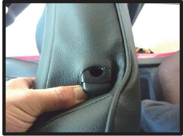
⑦ヘッドレストの台座を取り出します。図のように台座の片側のフチに生地をしっかりと入れ込みます。
