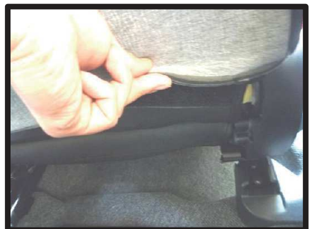
⑨⑤で引き出した生地とカバー背面下を、マジックテープで固定します。
