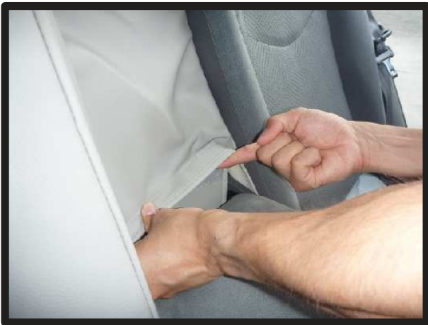
⑪引き出した生地をマジックテープで固定します。
