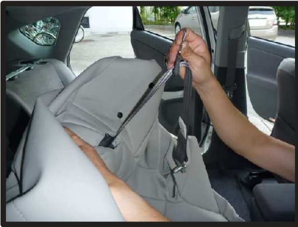
④カバーの加工穴からシートベルトを取り出します。
