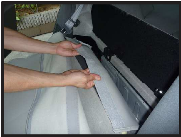
⑩ 背もたれを前に倒し、カバー前面の生地を引き出します
