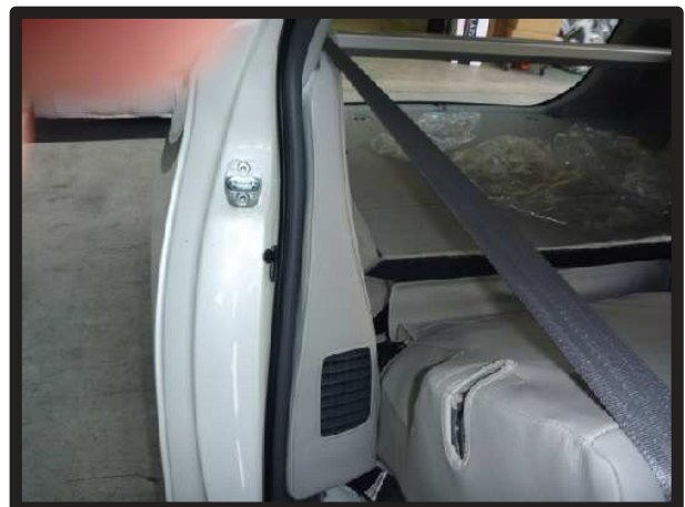
⑨サイドパーツ運転席側の完成です。 助手席側も一部形状は違いますが、 同様に取り付けます。
