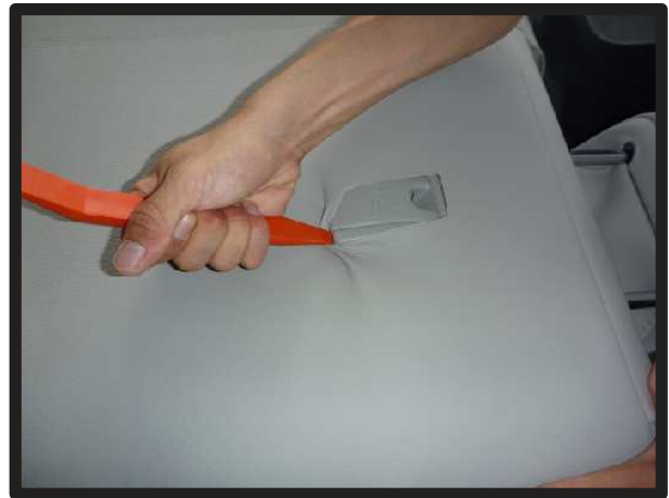
⑩ 背もたれ背面のチャイルドシート固定用バーをカバーの加工穴から取り出します。プラスチックのフチに生地を入れ込みます。
