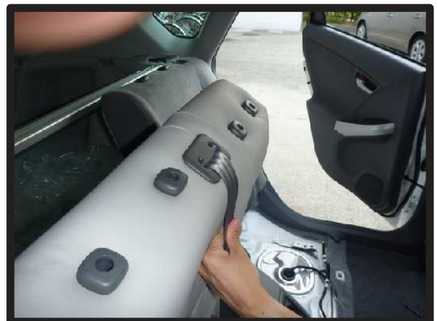
⑮シートベルトの台座を取り出した写真です。
