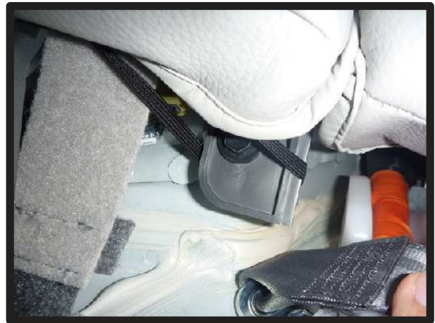
⑧サイドパーツ下側の生地にゴムが付 いています。ゴムはサイドパーツ自 体を固定しているネジが留まってい るプラスチックに引っ掛け固定しま す。
