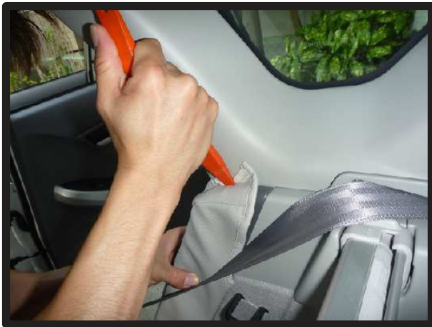
⑤先端部分も車体との隙間に生地を入 れ込みます。隙間が狭いため車体や カバーを傷付けないようにご注意下 さい。
