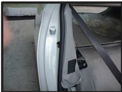
④生地を車体とサイドパーツの隙間に 入れ込んだ写真です。
