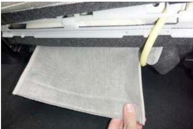
**7** 9ページ5番で入れ込んだ生地をシート背面から引き出します。この際、サイドエアバッグの配線・快適温熱シート装備車はシートヒーターの配線に注意して生地を引き出して下さい。
