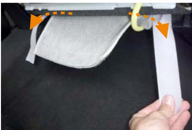
**8** 9ページ6番で入れ込んだマジックテープを引き出します。マジックテープは配線の外側に来るように中央部分から端へずらします。マジックテープ部分は強く引き過ぎると生地が破れたり縫製糸が切れるので、ご注意下さい。
