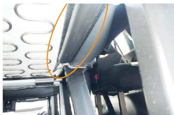
**11** シート内側面のプラフックを純正フックの上から固定します。
