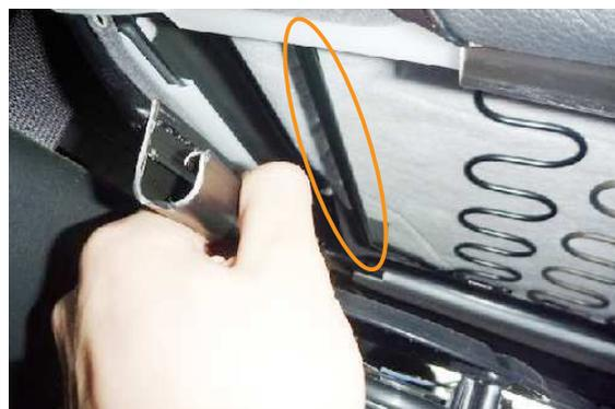
**9** カバー外側面のプラフックは純正フックではなく、図の○で示した金属バーに固定します。
