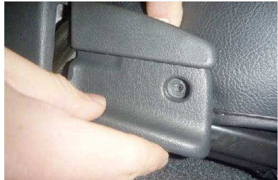
**10** プラスチックパーツを浮かせて隙間から生地を入れ込み、カバーの加工穴の位置を突起部に合わせてネジを元通り締めます。
