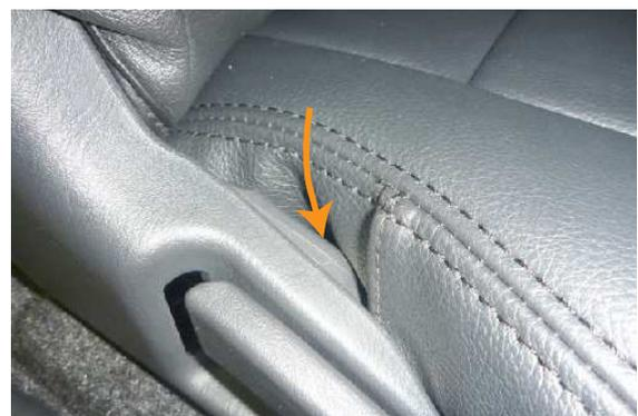
**11** シート外側面のリクライニングレバー周りの生地をシートの間隙に入れ込みます。多少形状は異なりますが内側面も同様に生地を隙間に入れ込みます。
