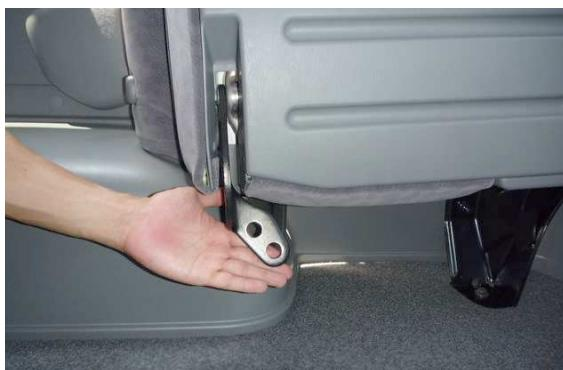
2 シート前側のステーを外した状態です。この後の作業で座面を倒したり跳ね上げたりしますが、後部のステーのみでシートを支えているだけですので、シートの可動は慎重に行って下さい。
