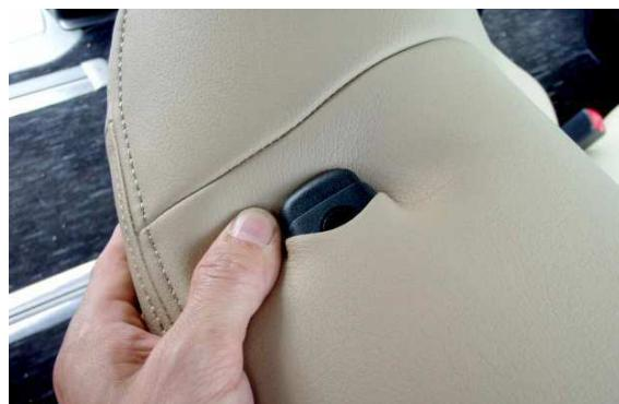
5 1列目と同様にしてヘッドレストの台座をカバーの加工穴から取り出します。
