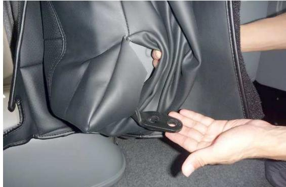
4 シートを跳ね上げて2番で外したステーをカバーの加工穴から取り出します。
