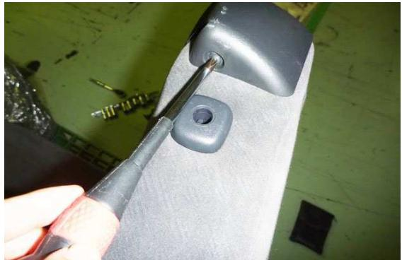
1 シートベルトガイド側面部のネジをドライバーで外します。
