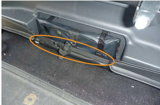
7 図の○部分で示したベルトとバックルを固定します。
