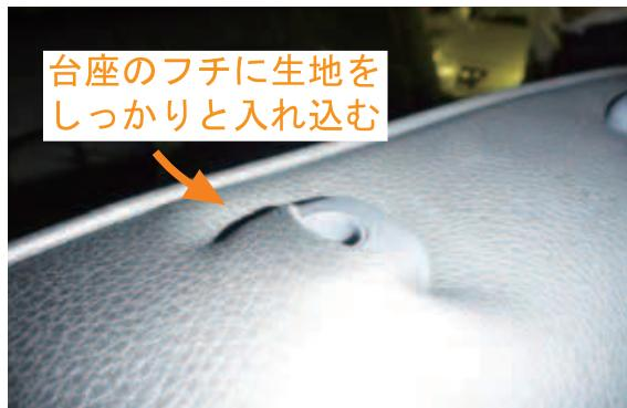
2 ヘッドレストの台座を取り出します。まず台座の片側のフチに生地をしっかりと入れ込みます。
