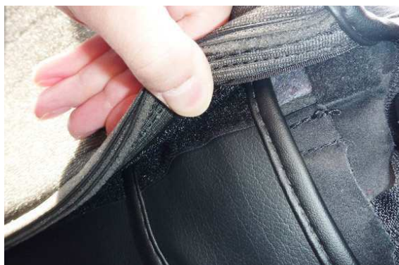
9 引き出した生地と背もたれ背面の生地を、マジックテープで固定します。
