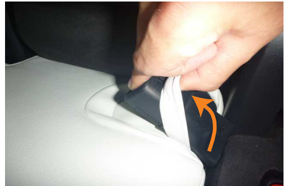
22 カバー奥に付いているゴムを中央のシートベルトバックルに通して固定します。カバーのラインを整えて、運転席側座面の完成です。助手席側は一部固定方法が異なる為 23 番をご覧ください。
