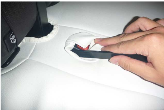
21 シートベルトバックル部分に生地を入れ込みます。隙間が狭くなっているのでヘラ等を利用して入れ込みます。
