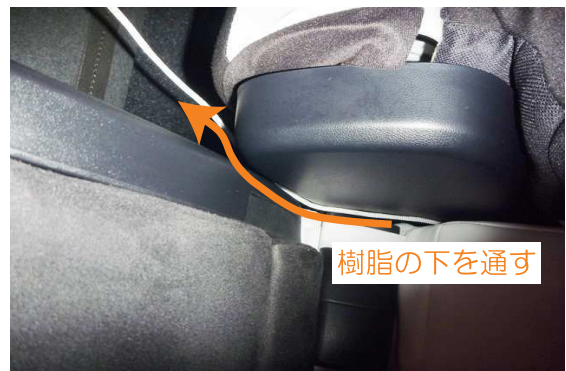
24 両端から出ているヒモを座面の背面へ回します。図はシート内側です。ヒモを樹脂の下を通して背面へ回します。
