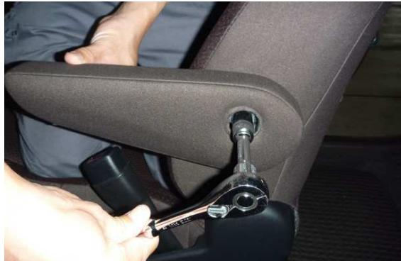
2 ソケットレンチを使用し、ボルトを外すとアームレストが取り外せます。
