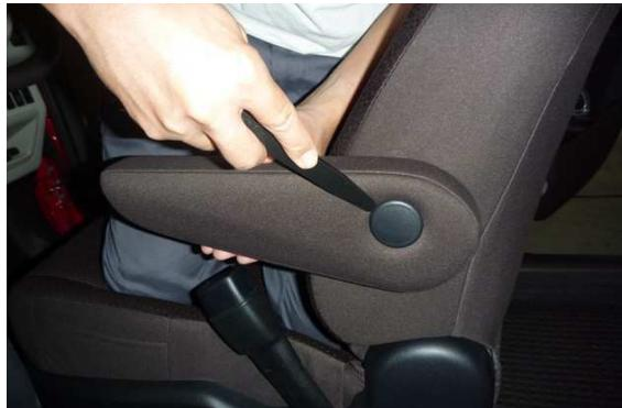
1 始めにアームレストを取り外します。側面に付いているキャップを取り外すと中にボルトがあります。
