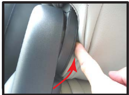
⑫シート正面からの付け根部分です。生地を隙間に入れ込みます。
