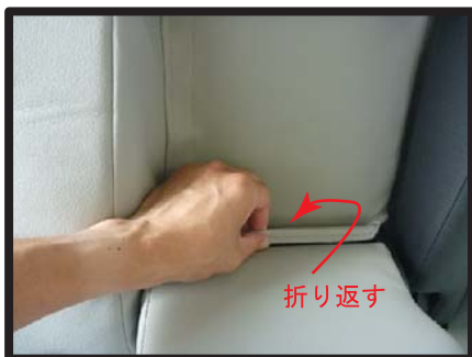
⑤カバーをプラスチックフックで固定します。アームレストを倒した際になる生地を折り返して、④で引き出した生地に挟むようにします。
