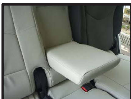
⑨カバーのラインを整えて、アームレストの完成です。
