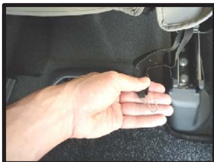
⑪1ページの⑤で引き出した端の生地には、ゴムが付いています。ゴムに付属のS字フックを取り付けて、シート裏の金属部分に引っかけて固定します。
