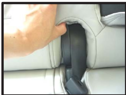
⑭シートの付け根に生地を入れ込みます。
