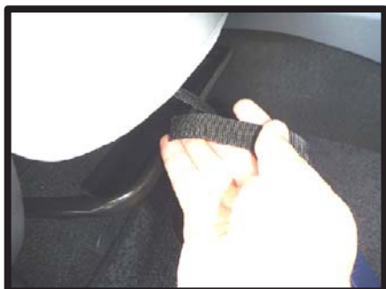
⑧カバー前方に付いているベルトを、リクライニングレバーの上を通してシートの背面へ回します。
