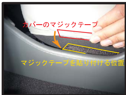
⑦カバー内側に付いているマジックテープを、シートに直接貼り付けて固定します。
