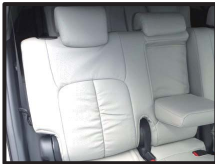
㉔カバーのラインを整えて、2列目運転席側背もたれの完成です。助手席側も形状は異なりますが、同様の固定方法で取り付けます。
