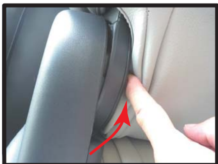
⑰シート正面からの付け根部分です。生地を隙間に入れ込みます。
