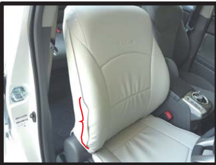
⑮こちらはカバーの取り付けの良くない例です。側面のシワが取れていません。6ページの⑦の作業をしっかりと行ない、生地をシートにしっかりと馴染ませて下さい。
