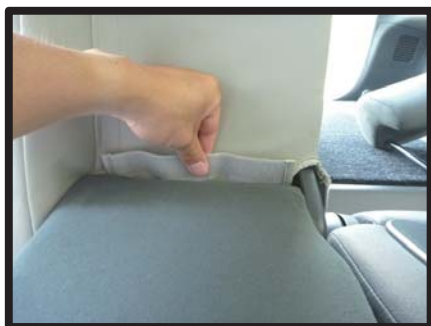
㉓入れ込んだ生地をアームレストを倒して引き出します。
