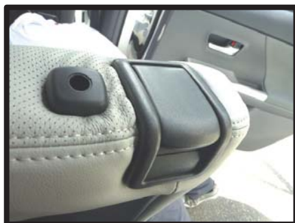
⑱レバーのフチに生地を全て入れて、レバーのネジを締め、元通りに固定して下さい。
