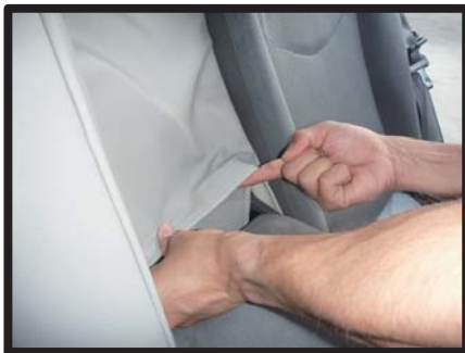
⑳引き出した生地とアームレスト収納部の下の生地を、マジックテープで固定します。
