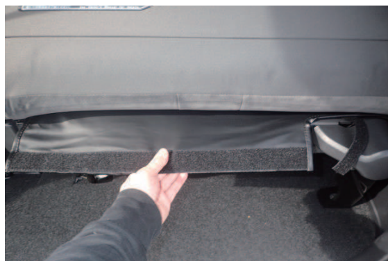
18 入れ込んだ生地を背面から引き出します。
