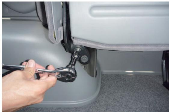
**1** シートを跳ね上げた状態で、シート前側のステーを外します。2本のボルトで固定されているのでソケットレンチ等を使用してボルトを外します。
