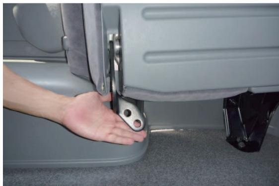
**2** シート前側のステーを外した状態です。この後の作業で座面を倒したり跳ね上げたりしますが、後部のステーのみでシートを支えているだけですので、シートの可動は慎重に行ってください。
