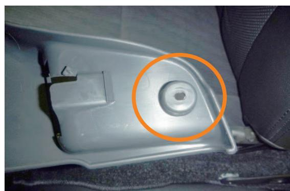
9 ネジで止まっているプラスチックパーツを裏から見ると図のようになっており、○で示した突起部にカバーの加工穴の位置を合わせます。
