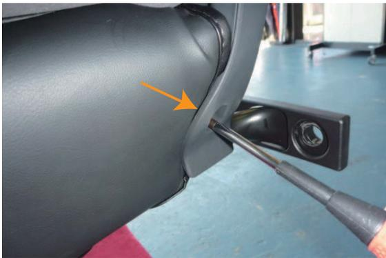
8 背面外側のネジを少し緩め、矢印部分の隙間に生地を入れ込みます。
