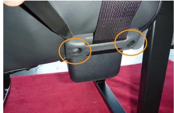
10 シートベルト周りのプラスチック部分に生地を入れ込みます。入りにくい部分は○部分のネジを緩めて作業して下さい。
