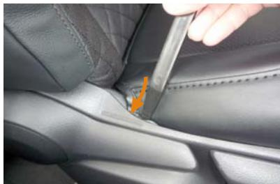
7 シート外側の付け根辺りは、隙間が大変狭くなっています。ヘラなどを使用してフラスチック部の内側に沿わせるようにして生地を入れ込みます。
