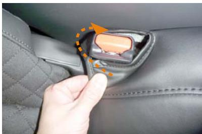
3 カバーの加工穴にシートベルトのバックルを通します。
