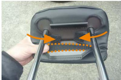
10 ヘッドレスト裏で生地を内へ寄せながらマジックテープを固定して、1列目同様にプラフックを固定します。
