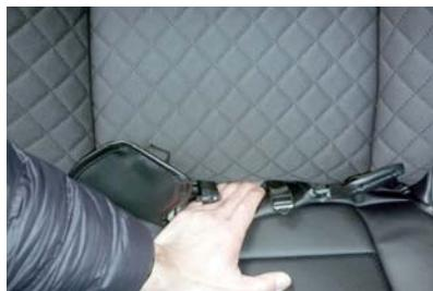
4 背もたれと座面の隙間に生地を入れ込みます。こちらは隙間が狭くなっています。シートを後ろ側に倒した状態で生地ができるだけ入れ込み、その状態でシートを起こすと生地が入り込みやすくなります。
