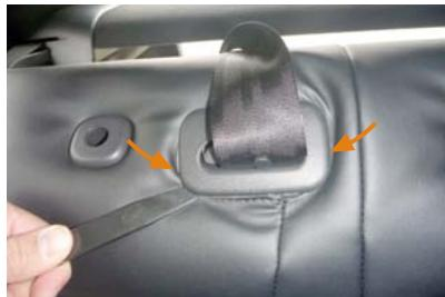
6 中央のシートベルトのフチに、ヘラなどを使用して生地を入れ込みます。フチのプラスチック部はツメが外れやすくなっているので、作業は慎重に行って下さい。
