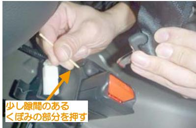
4 3点式中央シートベルトの固定を外します。中央シートベルトバックルの凹の位置を、先端が細いもので押すと、シートベルトの固定が外れます。図では爪楊枝を使用しています。中央シートベルトの固定が外れるとシートが車体から完全に外せます。
