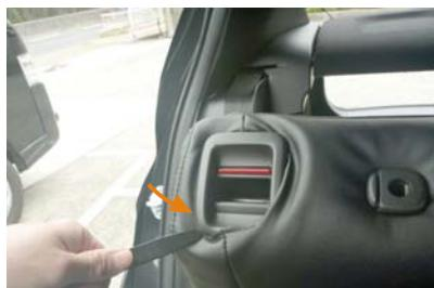
4 リクライニングレバーのフチに、ヘラなどを使用して生地を入れ込みます。リクライニングレバー部のプラスチック部はツメが外れやすくなっているので、作業は慎重に行って下さい。
