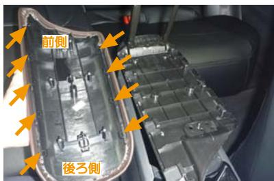
2 フタはネジとツメで固定されています。ツメは運転席側に5か所、助手席側に4か所あります。フタを外している図からツメのある位置を確認して下さい。
