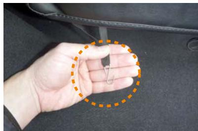
13 カバー背面下のゴムに付属の金属フックを付けます。
