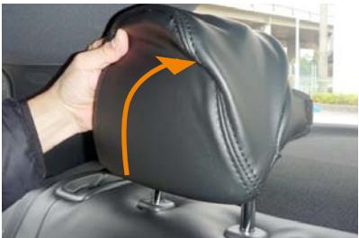
9 2列目ヘッドレストです。2列目ヘッドレストは図の矢印方向に、ヘッドレストのラインに合わせて下から上へかぶせます。カバーは平らなプラスチックが付いている方が前です。
