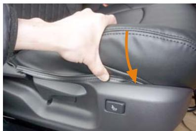
6 シートの外側です。シートとプラスチック部の隙間に、端に固定部材の付いた生地を入れ込みます。
