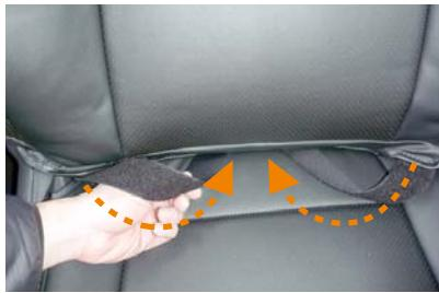
6 カバーの両端に付いているマジックテープはシートの端からでは隙間が大変狭いためシートの中央に寄せて入れ込みます。この後のシートの背面から引き出す際に、マジックテープがねじれないようにご注意下さい。
