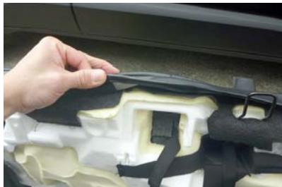
9 シートの軸部分の裏側にカバーのマジックテープをシートに直接貼り付けて固定します。
