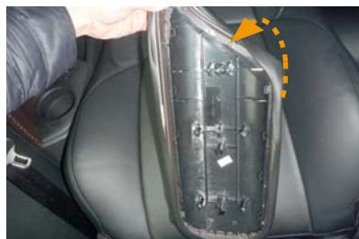
5 フタが外れたら、フタ部分にカバーをかぶせます。フタの後ろ側にカバーをかぶせて前側に引っ掛けるようにして全体にかぶせます。
