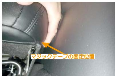
9 入れ込んだ生地の端にはマジックテープが付いています。マジックテープを直接シートに貼り付けて固定します。
