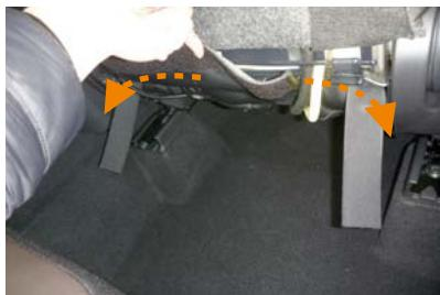
7 マジックテープをシートの背面中央部分から少し引き出して、図のように端にスライドさせるように寄せます。配線がある場合マジックテープは配線の外側に来るようにして下さい。
