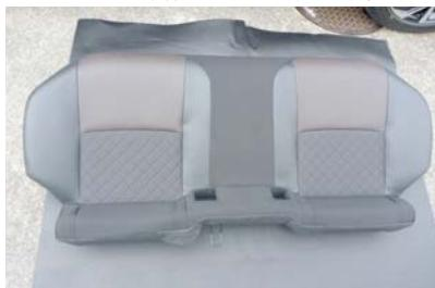
5 シートを車体から外して、車外の作業ができるスペースに置きます。シートを車体から外す際は慎重に作業を行って下さい。
