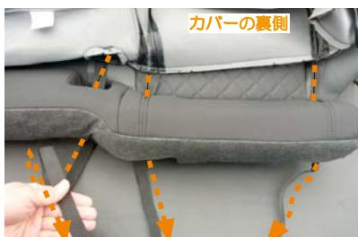
6 カバーの装着を行います。カバーの裏側に6本のベルトが付いています。6本のベルトをそれぞれチャイルドシート固定用の穴、シートベルトバックル収納部の穴に通して、シートの裏から取り出します。
