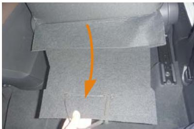
1 背もたれ背面からシート裏に固定されている生地を外します。生地はシート裏のフックに、ゴムで引っ掛けで固定されているので、ゴムの固定をほどき生地を外します。
