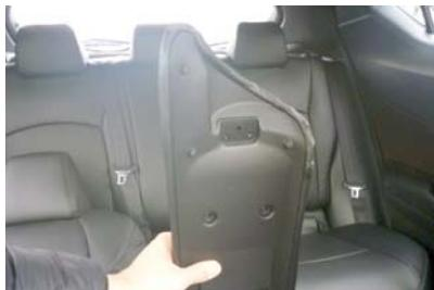
7 カバーを両面テープで固定したら、フタを元に戻します。まずツメの位置をしっかりと合わせて裏プラとはめ合わせます。
