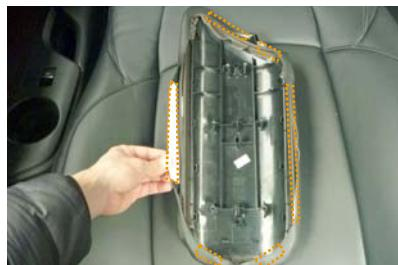
6 カバーの固定には両面テープの使用を推奨します。使用するテープは薄くて粘着力が強力なものが良いです。両面テープは図の点線部分を参考に貼り付けてフタの裏側に固定します。この作業で、仕上がりの精度がかなり異なります。
