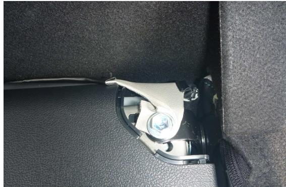
**16** 生地を挟み込みボルトを元通りに固定します。この際、生地が破れてしまうと固定が出来なくなるので、作業は慎重に行って下さい。ボルトを固定して**13番**で外したプラスチックカバーを元通りに固定します。プラスチックカバーのツメの位置に、生地が掛かっていると固定ができないため、その場合は生地をツメの位置に掛からないようはずらして、固定して下さい。
