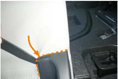
16 アームレスト軸部分の図のプラスチック部に、ヘラなどを使用して生地を入れ込みます。
