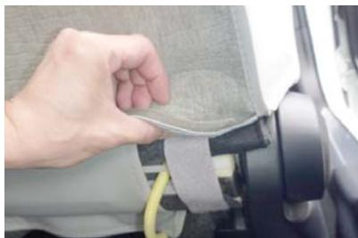
14 10ページ8番で引き出したマジックテープとカバーの背面下を固定します。引き出したマジックテープは長めに設計しています。丁度良い位置で固定して下さい。
