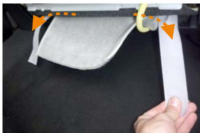
8 9ページ6番で入れ込んだマジックテープを引き出します。マジックテープは配線の外側に来るよう中央部分から端へずらします。マジックテープ部分は強く引き過ぎると生地が破れたり縫製糸が切れるので、ご注意下さい。
