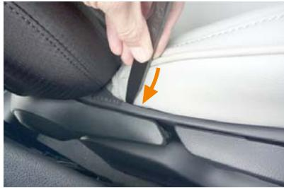
13 カバー外側のシート付け根部分は隙間が大変狭くなっています。ヘラなどを使用してプラスチック部の内側に沿わせるように、生地を入れ込みます。
