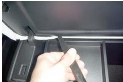
5 ここからはひたすらフチに生地を入れ込んでいきます。ヘラなどを使用して生地を入れ込みます。アームレストのフタを開けた状態で作業をするので、破損させないよう生地を入れ込む際は、フタ部分をしっかりと支えて作業を行って下さい。
