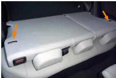
20 図のシートを固定する受け部分にカバーの加工穴があっているか確認して下さい。加工穴は少し大きめに開けていますが、すりで受け部分を塞いで使用すると、生地が破れる恐れがあるので、ご注意下さい。
