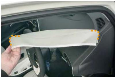
1 カバーの前後を確かめます。図の点線のカーブの部分が短い方が前になります。
