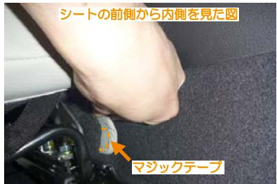
15 カバー内側面下の前後にマジックテープが付いています。こちらも直接シートの生地に貼り付けて固定します。
