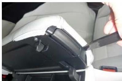
6 アームレストの先端部分に生地を入れ込みます。生地が入れ込みづらい場合は、ヘラのみを隙間に入れ、生地の入る角度を確認してから生地を入れ込むと作業が行いやすくなります。
