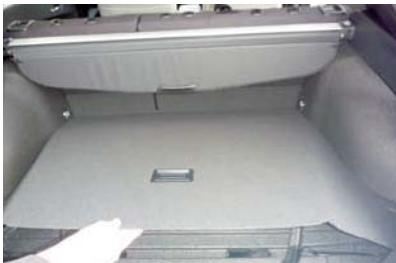
**1** カバーの装着を行う前に、トランク側からラゲージボードを外します。
