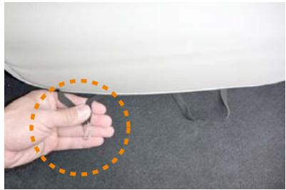
15 カバー背面下のゴムに付属の金属フックを付けます。
