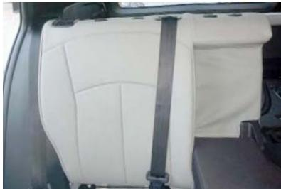
21 カバーのラインを整えて、2列目運転席側背もたれカバーの完成です。アームレスト収納部はアームレストカバー装着後、アームレストをしばらく背もたれ側に収めた状態にしておくと生地がシートに馴染んでいきます。
