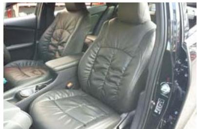
7 アームレスト軸部分の生地を、ヘラなどを使用して隙間にしっかりと入れ込みます。
