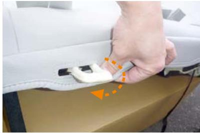
7 シート背面のコの字型のフックにカバーの加工穴を通します。
