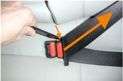
**19** シートベルトバックルとシートの隙間は大変狭いため、バックルがなかなか出てこない場合はシートベルトを差し込み引き出すと作業が行いやすくなります。
