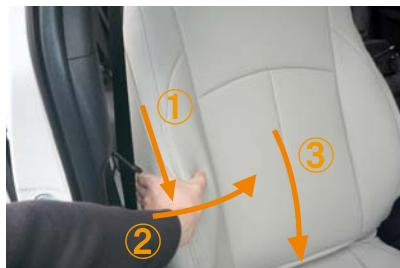
10 カバー側面の生地を、図の①～③の順番でシートに密着させるようにして、シワをなくしていきます。側面の生地がしっかりと張るまで繰り返し行って下さい。
