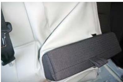
**3** アームレストを斜めに倒してカバーの加工穴から出します。
