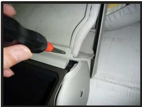
⑧上フタのプラスチックパーツを外します。 ネジをドライバーで外します。ツメで固定されているので、ヘラ等で外します。(各4箇所)
