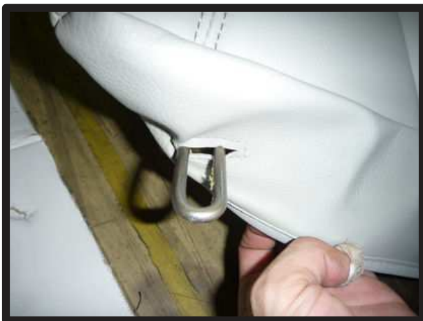
⑨カバーの加工穴から金属部分を取り 出します。
