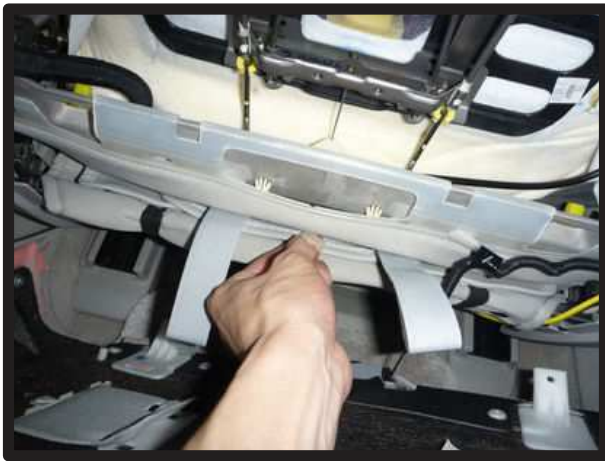
④入れ込んだ生地を背面から引き出します。
