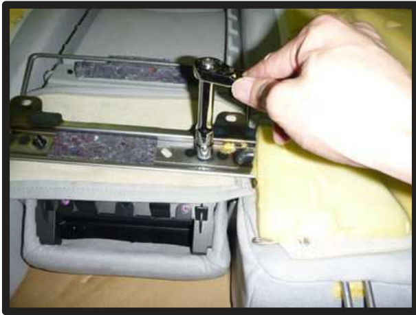
⑦アームレストを外します。 裏のナットをラチェット等で取り外 します。
