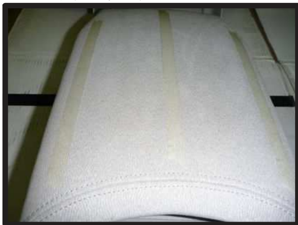
⑨カバー取り付けにはアームレストに両面テープ等を付けて作業すると、より強固に固定できます。
