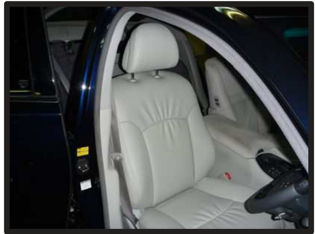
⑧カバーのラインを整えます。 ヘッドレストバックボードを元に戻して、1列目背もたれの完成です。 助手席側も同様に取り付けます。
