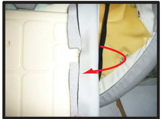
⑩側面の生地を裏側まで巻き込み両面テープ等で固定します。
