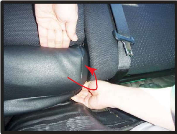
⑩シート内側面のアームレスト下部分にも、生地を引っかけるようにしてかぶせます。
