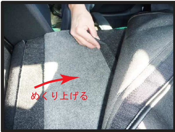
⑪シート背面下の図の生地を、めくり上げてカバーの中へ入れ込みます。
