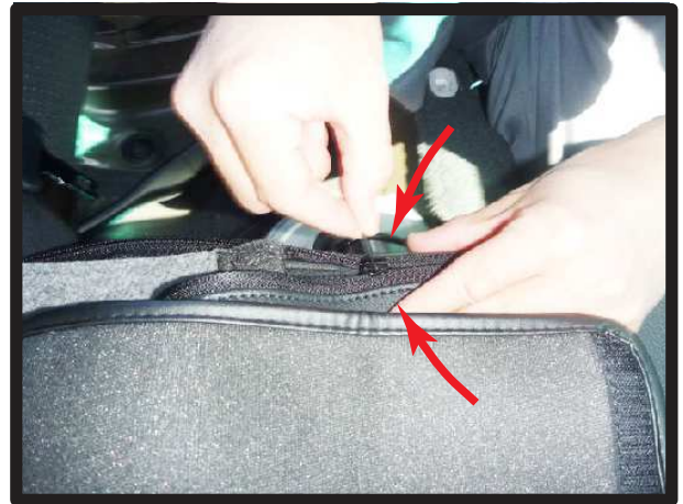
②カバー内側面のファスナーを、生地を内へ寄せながら閉じます。
