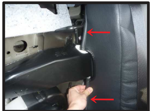
⑫サイドパーツを車体に戻して、内側面の生地を矢印方向に引っ張ります。助手席側の背もたれを起こしてロックすることで、生地が挟み込まれ固定されます。
