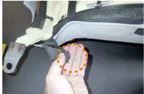
28 シート下の両端に幅の広いゴムが付いています。ゴムに付属の金属フックを取り付けます。
