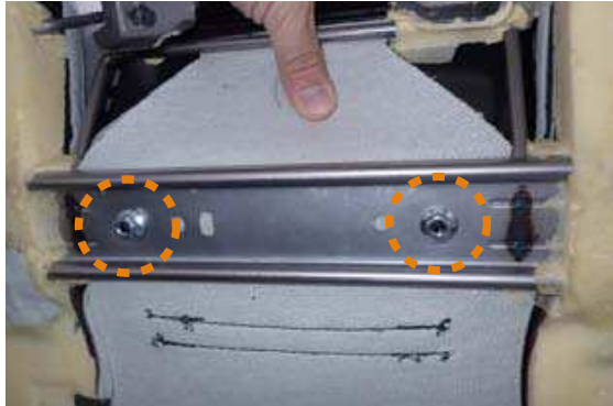
49 シート裏から軸が出てきたらナットで固定します。
