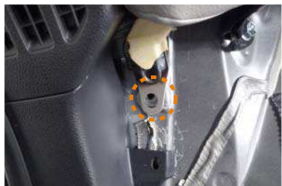
54 シートの下側、両端のボルトの穴位置が合っているかを確認します。
