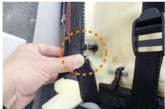
29 金属フックをシート裏の図の位置に引っ掛けて固定します。
