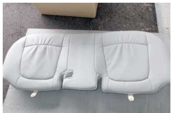
18 カバーのラインを整えて、2列目座面の完成です。シートは背もたれカバーを装着して、背もたれシートを車体に戻した後に、車体へ戻して固定します。
