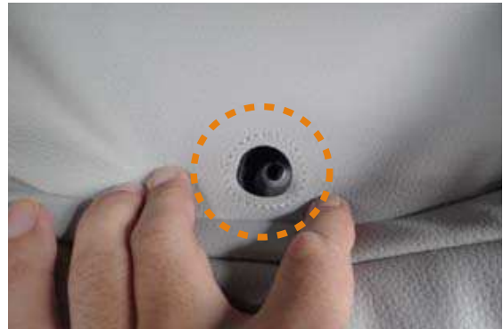
52 ヘッドレストを外したところにあるボルトの穴位置が合っているかを確認します。
