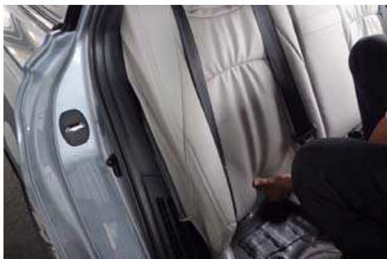
51 シートを車内へ慎重に運び込み、シートベルトをかわしながら位置を合わせます。シート側面までカバーで覆っているため、シートを戻す作業が少々きつめに感じられる場合があります。左右均等に幅を合わせながら、車体側へ押し込むようにして、シート位置を合わせて下さい。
