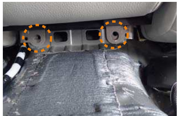
53 アームレスト下のボルトの穴位置が合っているかを確認します。
