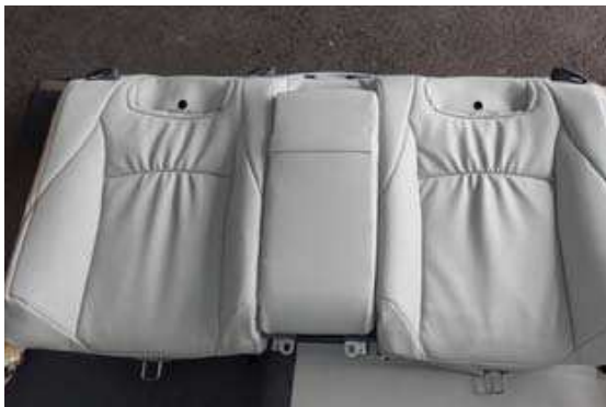
50 アームレストを固定出来たら、シートを車体に固定しなおします。
