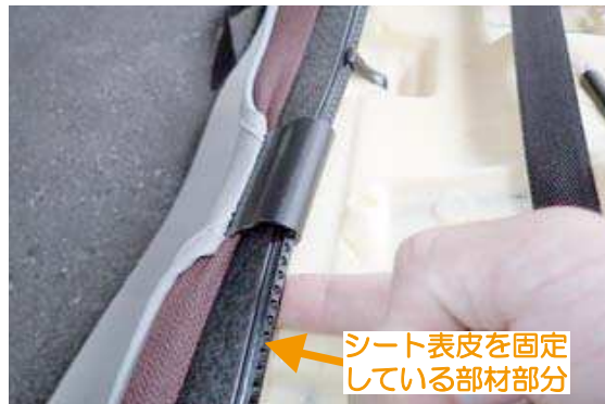
26 カバーの両端に3個ずつ付いているフックを、シート裏の図の部分に引っ掛けて固定します。
