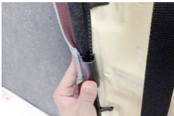
27 フックをシート裏に持ってきて、図のように26番のシート表皮を固定している部材に引っ掛けて固定します。
