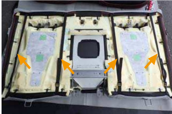
25 シートを裏返します。シート裏でベルト4本を固定します。
