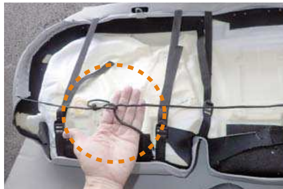
14 作った輪にもう片方のヒモを通します。通したヒモを引くと、カバーの下周りが絞り込まれていきます。
